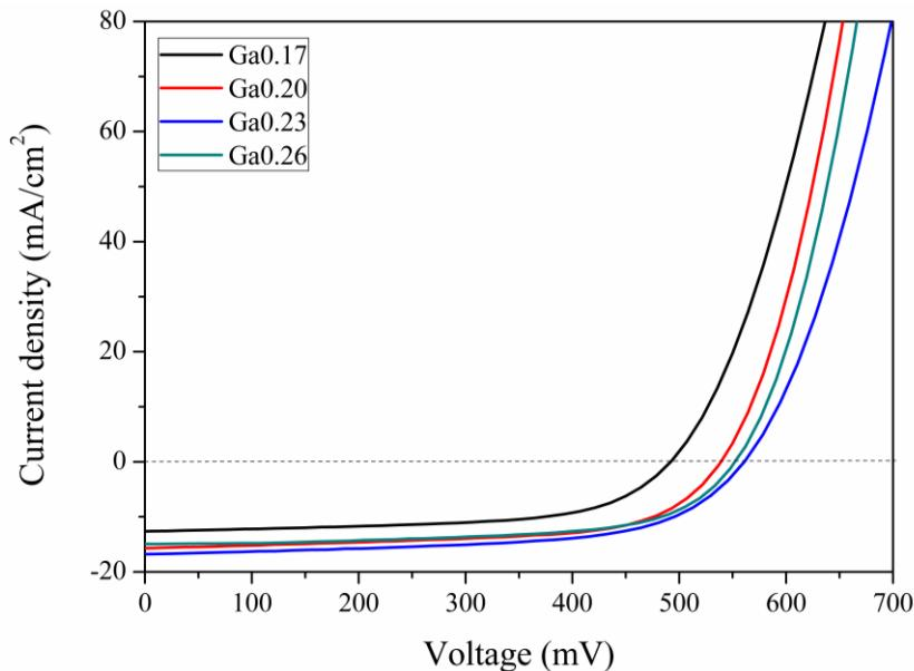
**Figure 3.** Current density-voltage graphs (Akım yoğunluğu-voltaj grafikleri)
