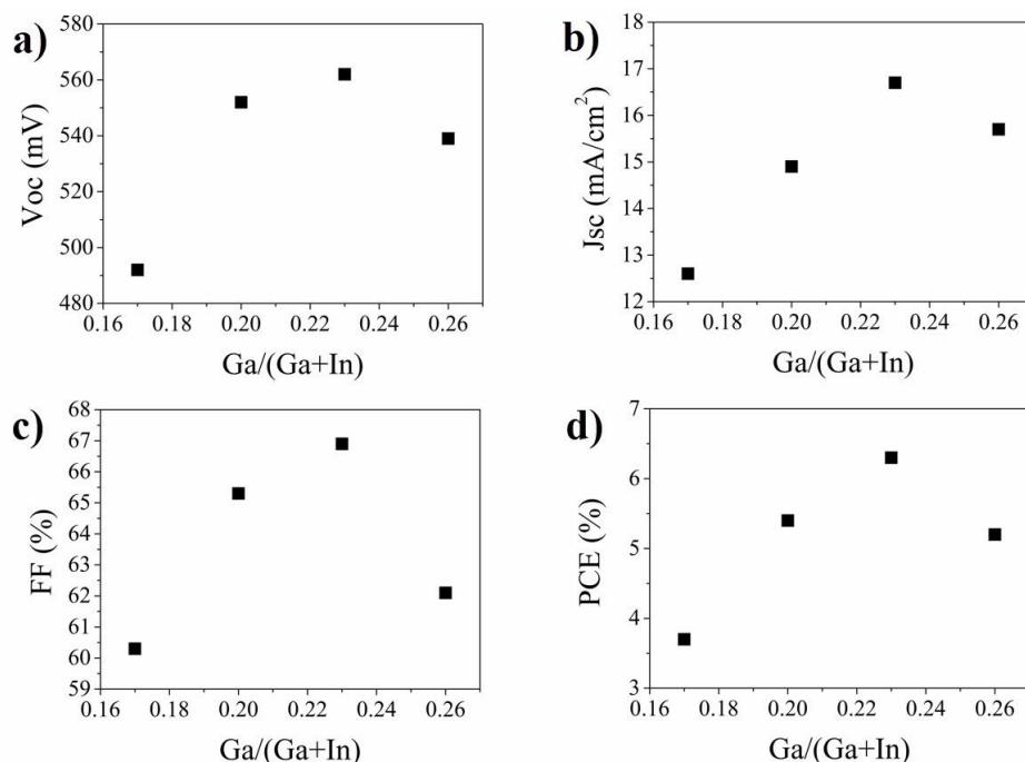
**Figure 4.** The trend in the change of the solar cell parameters a)  $V_{oc}$ , b)  $J_{sc}$ , c) FF, and d) PCE (Güneş pilin parametrelerinin değişim eğilimi a)  $V_{oc}$ , b)  $J_{sc}$ , c) FF ve d) PCE)
